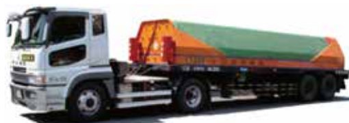
水素トレーラー
