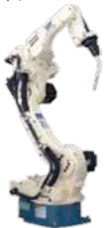
溶接ロボット
