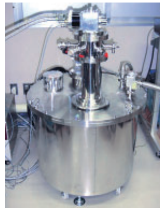
ソレノイド型直冷式マグネット仕様 Solenoid type direct cooling magnet specification
